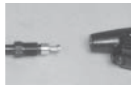
Montage du tuyau du maître-cylindre des HFX – 9
