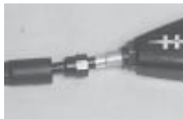
Montage du tuyau du maître-cylindre des HFX-Mag
