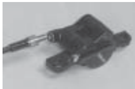
Montage du tuyau de l'étrier G2
