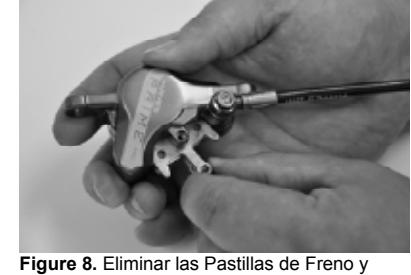
Figure 8. Eliminar las Pastillas de Freno y "sandwich" resorte
