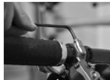
Figure 1. Apriete el lateral de la pinza con el Prime logo hasta que no exista ningún hueco.
