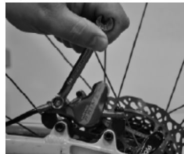
Figure 3. Afloje el banjo pernos para ajustar la manguera ángulo.
