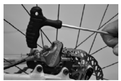
Figure 6. Montar la Calibrador en el Cuadro
