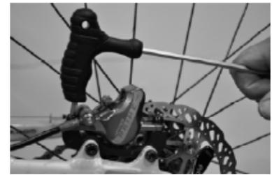
Figure 6. Monter l'étrier sur la cadre
