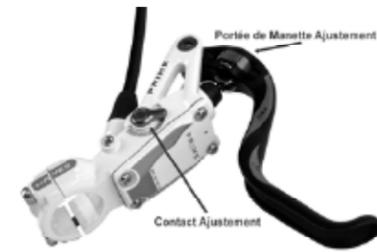
Figure 4. Le Contact ajustement, ou "morts course" ajustement et portée de manette ajustement.
