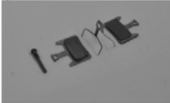
Figure 9. Les plaquettes de frein, "sandwich" ressort, et Plaquettes de frein l'épingle de de retenue
