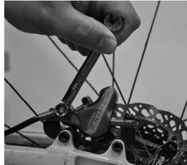
Figure 3. Desserrer le banjo boulon d'ajuster le tuyau angle.
