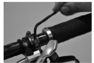
Figure 2. Serrer bas guidon clamp vis pour 3.37±0.55Nm (30±5 po-lb)
